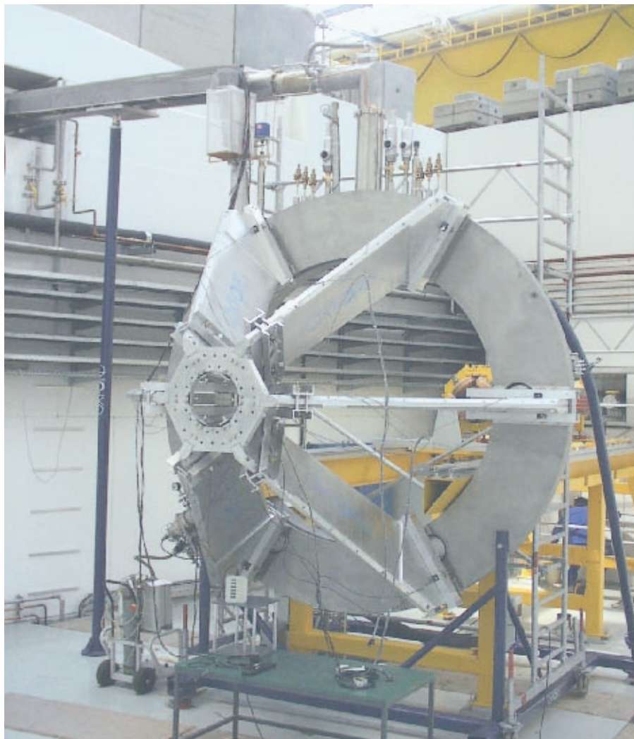
Abbildung 2.1: Foto des HADES-Magneten, aufgenommen während der Inbetriebnahmephase. Man sieht die sechs Spulen(kästen), welche ein toroidales Magnetfeld erzeugen. Im Vorder- und Hintergrund sind der kleine und große Stützring zu sehen, im Kreis angeordnet die sechs Spulenkästen. Oben sind die Zu- und Abführungen zur Kühlung und Stromversorgung zu erkennen. (weitere Informationen im nachfolgenden Text).
