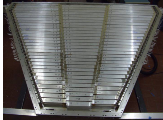
Abbildung 2.10: Der Aufbau des RPC Detektors. Links: Eine Zelle besteht aus drei Aluminium Elektroden und zwei Glasplatten, in der Mitte liegt die Hochspannung an. Nach außen ist die Zelle abgeschirmt. Rechts: Ein Sektor des RPC Detektors besteht aus zwei Ebenen, die sich jeweils aus drei Spalten und 31 Zeilen zusammensetzen.
