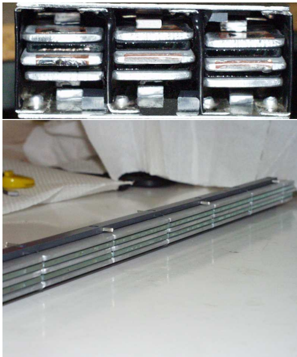
Figure C.2: Vista dianteira do prototipo coas tres celdas no seu interior. A celda máis cara á esquerda foi substituída por outra de electrodos de vidro. Na fotografía de embaixo móstrase unha das celdas RPC antes de ser introducida na blindaxe.
