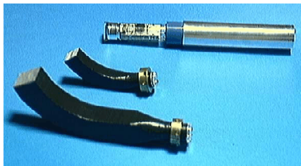
Abbildung 2.10: Photomultiplier (oben) mit Lichtleitern (mitte und unten)
