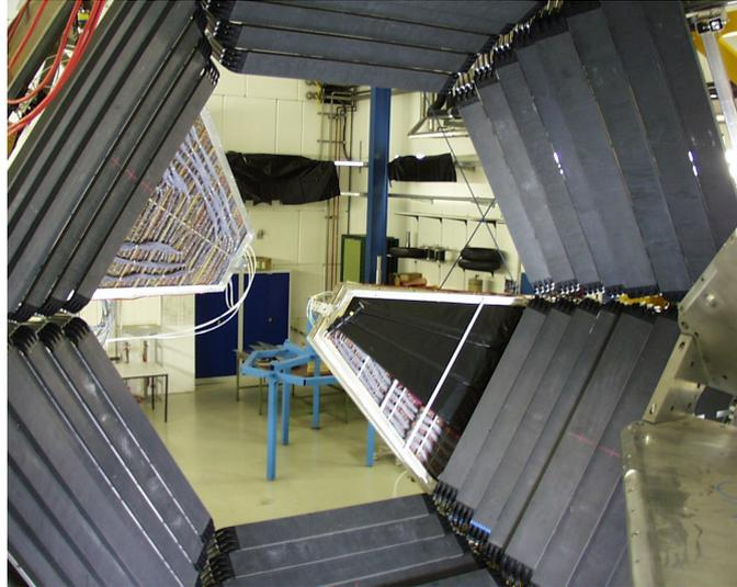
**Abbildung 4.6:** Bild der TOF- (sechs Sektoren im Vordergrund), TOFino- und Shower-Detektoren (im Hintergrund). Es sind nur zwei Sektoren des Shower-Detektors zu sehen. Einer dieser Sektoren ist mit drei TOFino-Modulen bestückt.
