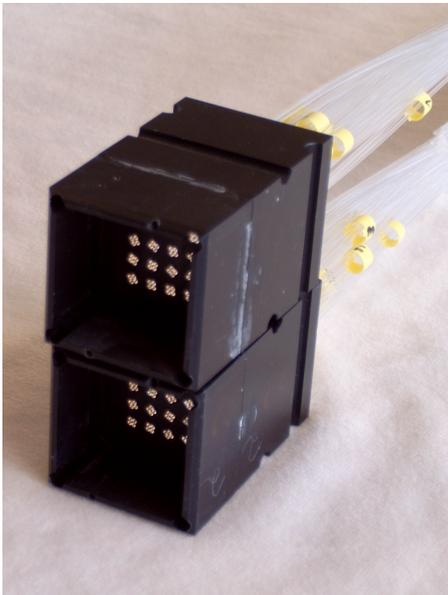
**Abbildung 5.18:** Seitliche Ansicht der Prototypen. Die Photomultiplier werden in den Plastikvorsatz geschoben und schliessen mit dem Eintrittsfenster direkt an den polierten Enden der Lichtleiter an. Deutlich zu erkennen sind jeweils die vier Lichtleiter pro Photomultiplier-Pixel.
