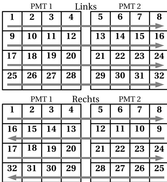
**Abbildung 5.4:** Anordnung der Kanäle auf den Photomultipliern. Durch die unterschiedliche Anordnung rechts und links wird das koinzidente Übersprechen in nicht benachbarte Kanäle, nach oben bzw. unten, unterdrückt.
