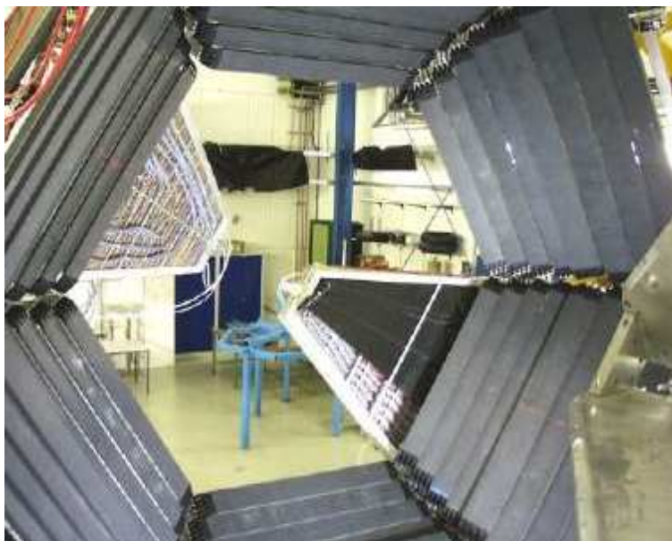
Rysunek 4.7: Zestaw detektorów czasu przelotu TOF (zewnątrzne 6 sektorów). Wewnątrz dwa sektory PreShower na których umieszczona jest część TOFino.
