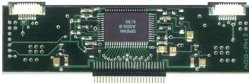
ABBILDUNG 3.3: Prototypversion des Daughterboards, (JINR, Dubna). In der Mitte der Platine ist der ASD8-Chip zu erkennen. Links und rechts oben sind die Verbindungskontakte zur Kammer, unten der zur TDC-Mutterplatine. (Höhe: 30 mm, Breite: 110 mm)
