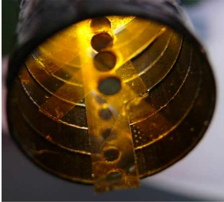
**Abbildung 2.3:** Optische Überprüfung des Targets: Nb-Scheiben auf Kaptonstreifen, eine reflektierende Folie ermöglicht die Analyse aller Targetelemente.
